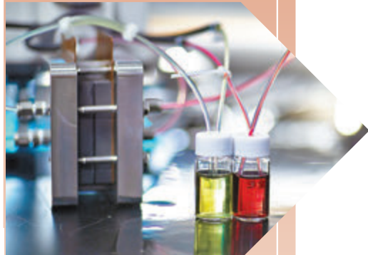
「簡版」的水系液流電池系統。受訪者供圖
