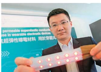
●鄭子劍率領研發的「液態金屬纖維氈」透氣度高，而且極具彈性，導電能力高，適用於穿戴式電子設備。理大供圖
