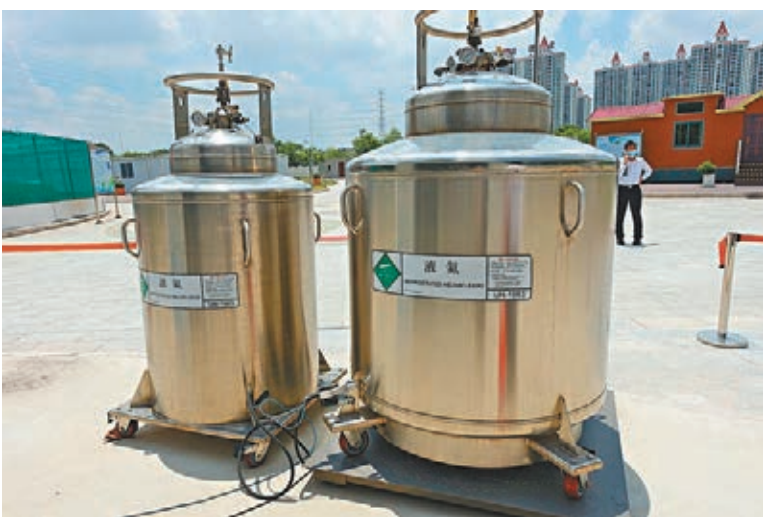
●儲存液態氫的裝置。記者了解到，內地加氫站建設標準比外國嚴格，加氫站內帶電元件均為防爆元件。
