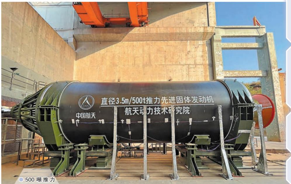
●500噸推力整體式固體發動機。
