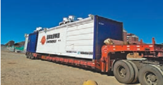
◆中集安瑞科為北京冬奧提供的中集氫能70兆帕撬裝全集成加氫站設備。
