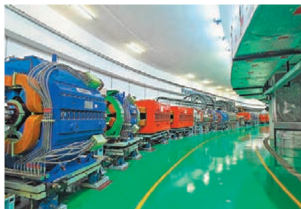
◆中國散裂中子源內設。圖為檢修狀態下的快循環同步加速器。資料圖片
