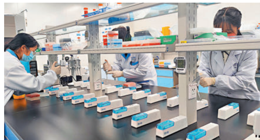
◆ 研究團隊自主研發了DNBelab C4便攜式單細胞系統，結合DNBSEQ測序平台於2020年開始推動細胞圖譜工作。圖為研究人員使用DNBelab C4進行測試。
