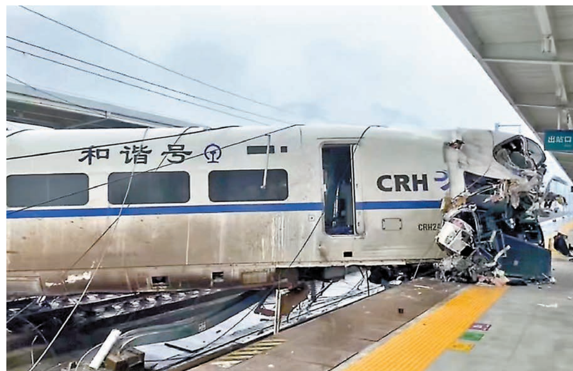
6月4日10時30分許，貴陽北至廣州南的D2809次旅客列車行駛在貴（陽）廣（州）線黔東南苗族侗族自治州榕江站進站前的月寨隧道口時，撞上突發溜塌侵入線路的泥石流，導致7號、8號車發生脫線。中新社
