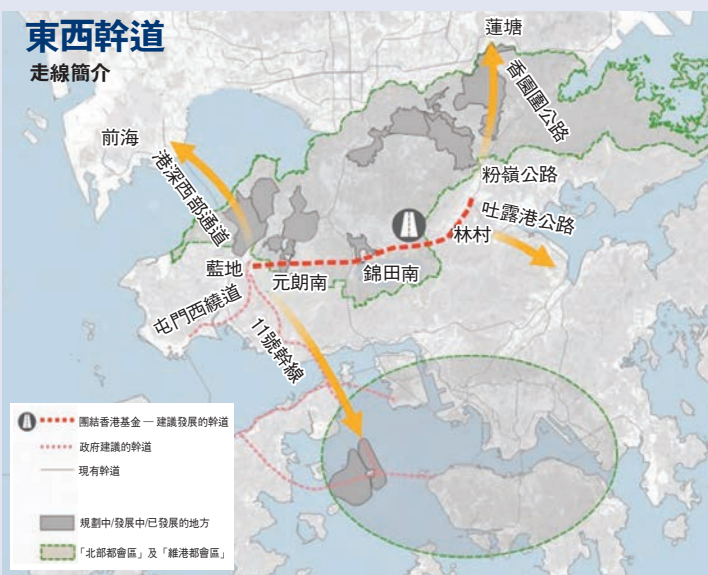
◆東西幹道東面連接粉嶺公路及吐露港公路，可沿香園圍公路直達深圳蓮塘；西面經港深西部通道接駁深圳前海，並連接擬建的屯門西繞道及11號幹線。走線將途經以下地區：林村、錦田南、元朗南、藍地。長度約17.7公里。工程主要為擴闊現有粉嶺公路。 團結香港基金供圖
