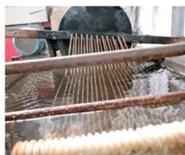
將膠磚放入機器內進行「拉絲」工序及冷卻，再打碎成粒狀膠珠
