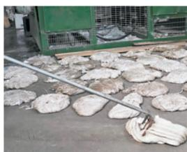
膠箱經機器打碎，透過熱熔工序，將其壓縮成長條狀，並製成膠磚
