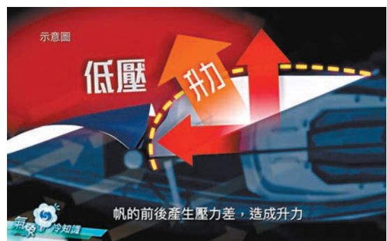
◆當空氣流經弧形的帆面，帆的前後產生壓力差，造成升力。 影片截圖
