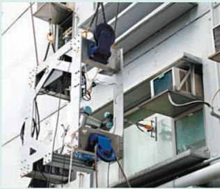
◆ 線控機械人系統能在大廈外牆進行高空工作。圖為抹窗示範。中大供圖
