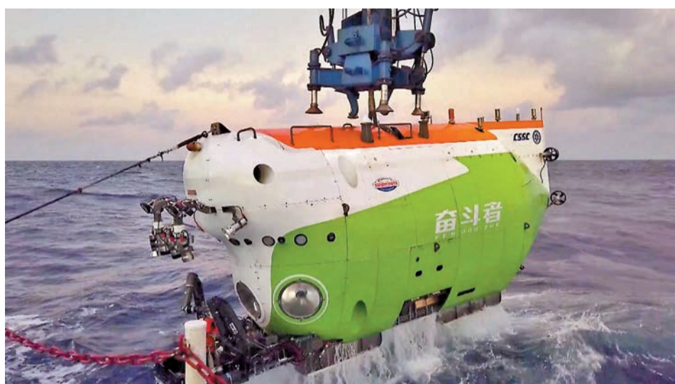
◆全海深載人潛水器「奮鬥者」號體現了中國在海洋高技術領域的綜合實力。作者供圖
