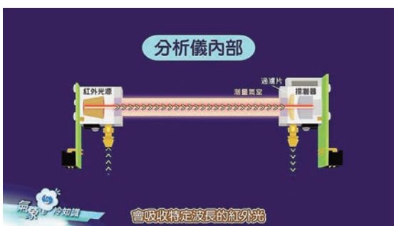
◆ 由於二氧化碳分子會吸收特定波長的紅外光，探測器便可根據測到的紅外光強度，知道空氣中二氧化碳的濃度。影片截圖
