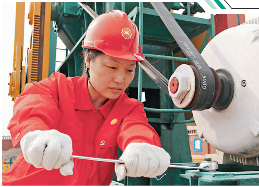
劉麗在緊固抽油機電機上的固定螺絲。
