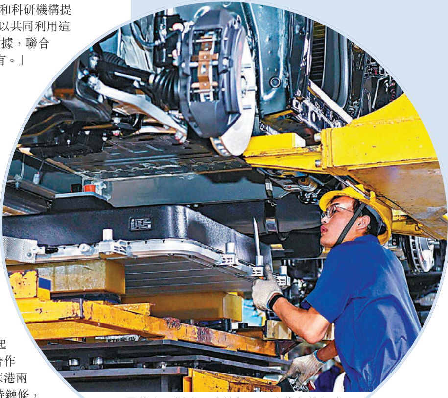
◆早前在深圳比亞迪總部，工人為新能源汽車安裝電池。
