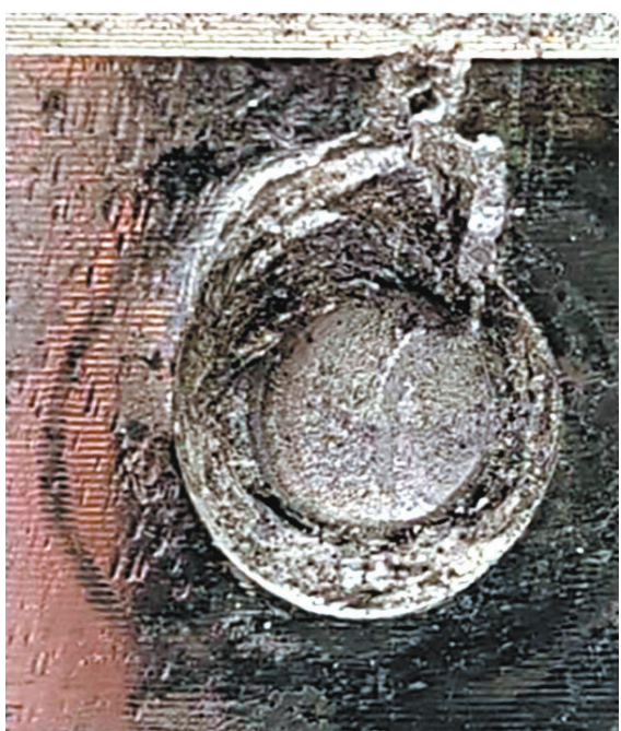
◆肇事Getinge手術燈的6口螺絲全部斷裂。醫管局圖片
