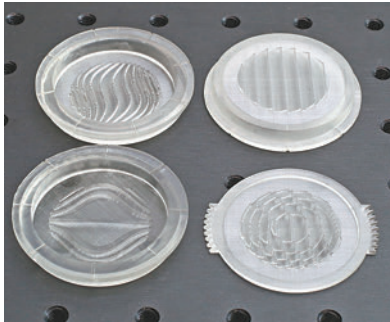
◆超構表面由逾15,000個以三維打印技術製成的微小人造超構天線組成。城大圖片
