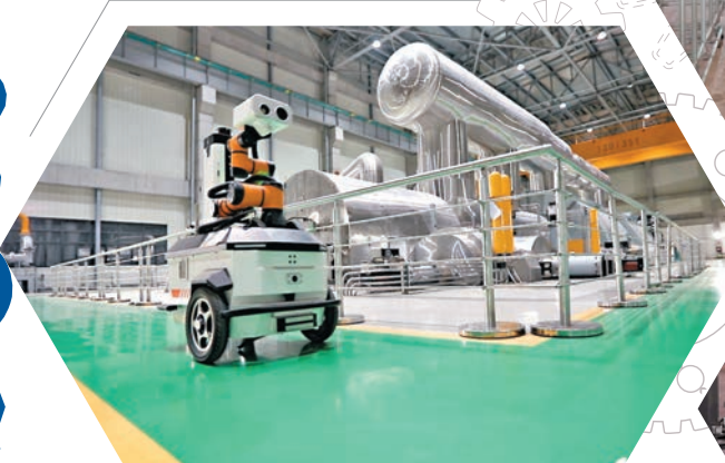
◆電影中的移動機械人於現實的傳統能源火電廠中執行智能巡檢任務。 網上圖片
