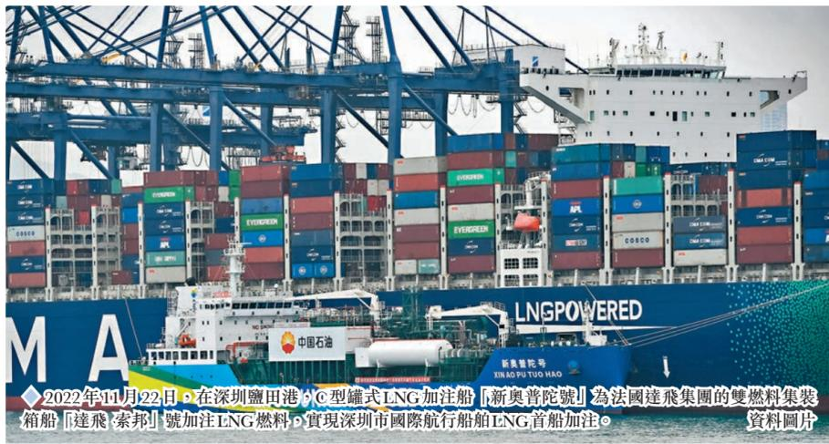
2022年11月22日，在深圳鹽田港，@型罐式LNG加注船「新奧普陀號」為法國達飛集團的雙燃料集裝箱船「達飛·索邦」號加注LNG燃料，實現深圳市國際航行船舶LNG首船加注。
