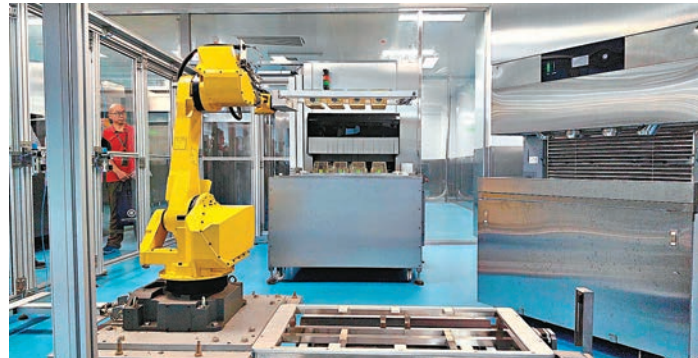
◆位於腦設施的全自動物流運輸和清洗系統已經可以使用，機械臂在籠具中倒入新的墊料。 香港文匯報記者郭若溪 攝
