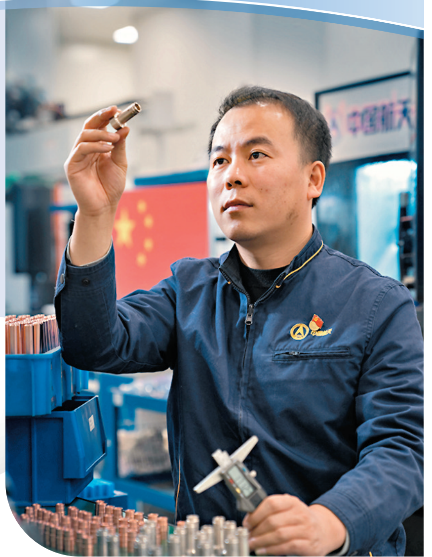
◆何小虎測量火箭發動機燃燒室噴嘴的尺寸。
