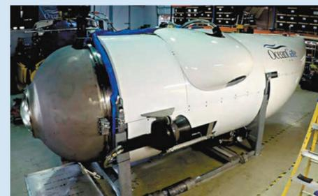
◆專家估計泰坦號船身採用碳纖維製造，缺乏彈性容易破裂。網上圖片
