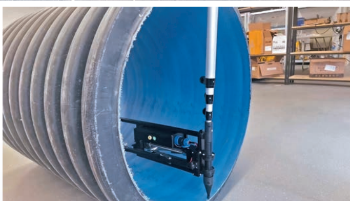
▲圖為針對內地地下管網情況研發的管道檢測機器人。
