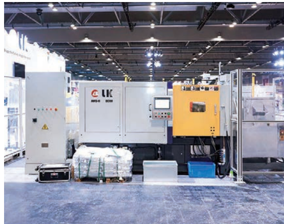
▲▲ 現場演示 高效、自動生產 玩具車外殼的熱 室壓鑄機。
