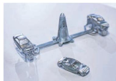
▲▲ 現場演示 高效、自動生產 玩具車外殼的熱 室壓鑄機。
