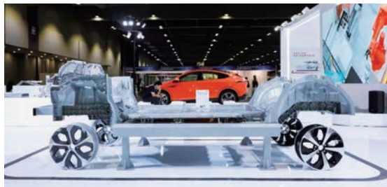
▲▲ 圖為一體化壓鑄成型之鑄件。
