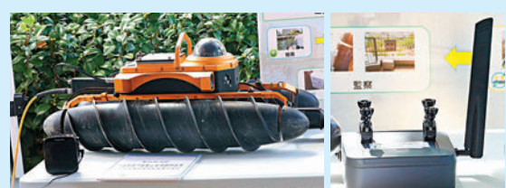
◆管網檢測機械人「聲探」(左圖)、沙井監察攝影機(右圖)協助追查雨水系統的污染源。 香港文匯報記者萬靈霜攝
