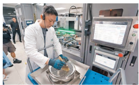
◆「自動普氏壓實試驗系統」提升測試效率和質素。香港文匯報記者曾興偉攝
