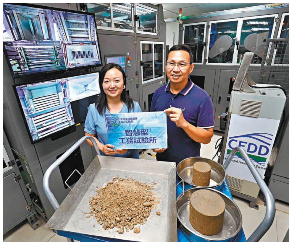
◆楊暉(左)表示，採用「自動普氏壓實試驗系統」後，一個測試僅需一名工作人員。香港文匯報記者曾興偉攝
