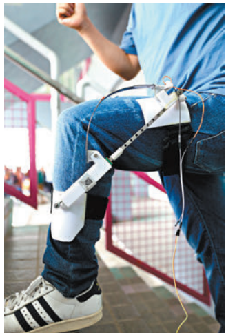
▲廖維新團隊研發的極輕便人體動能電力採集系統，能夠將步行時膝部彎曲的動能轉化為電力。
