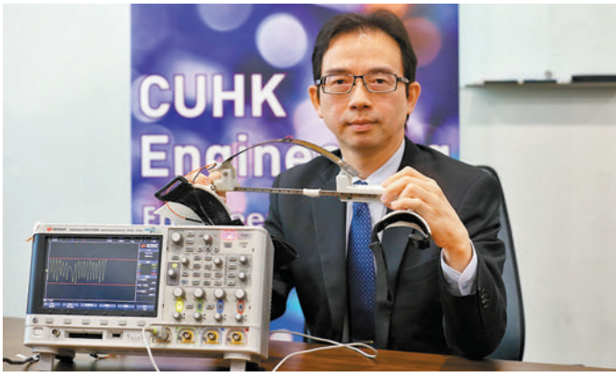
▲廖維新團隊研發的極輕便人體動能電力採集系統，能夠將步行時膝部彎曲的動能轉化為電力。
