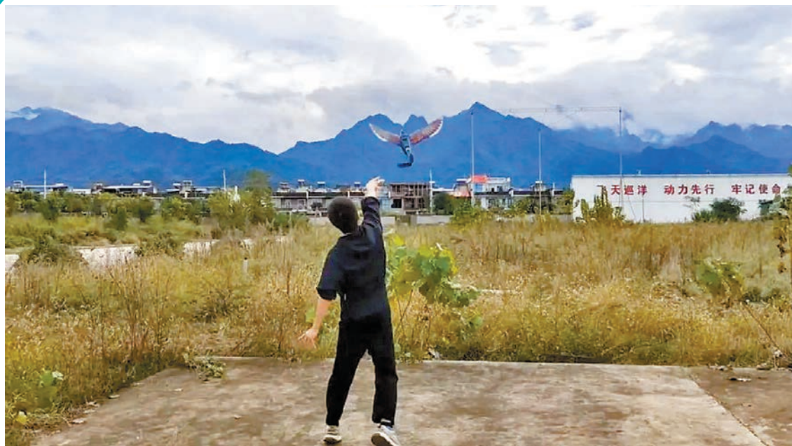
◆小型化仿生飛行器一般為手拋起飛、滑翔降落。圖為「信鴿」手拋起飛。 香港文匯報西安傳真
