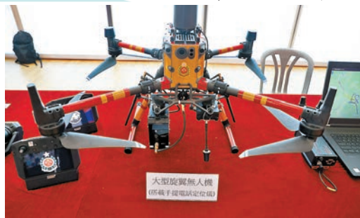
▲▲消防無人機一般人手操作，亦可配合電腦輸入程式飛行拍攝指定範圍和距離。
