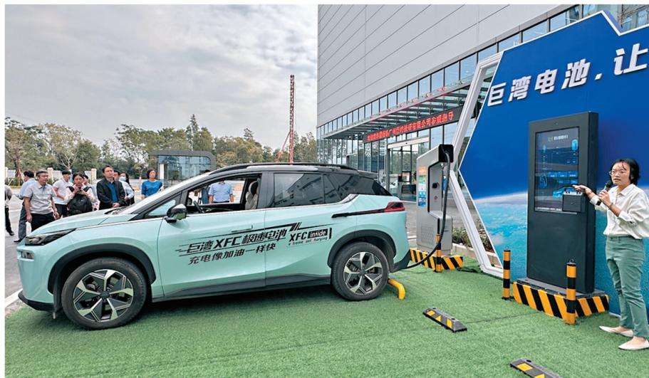
◆巨灣技研自研的XFC極速充電動力電池,從33%充電到45%僅需不到一分鐘的時間。
