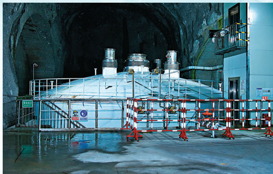
◆位於中國錦屏地下實驗室(CJPL)二期的中國暗物質實驗CDEX-1T大型液氮恒溫器。新華社
