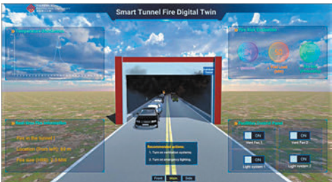
◆理大團隊設計了一個數字孿生監測系統，在看不見隧道內實際狀況時亦能進行風險監測。
