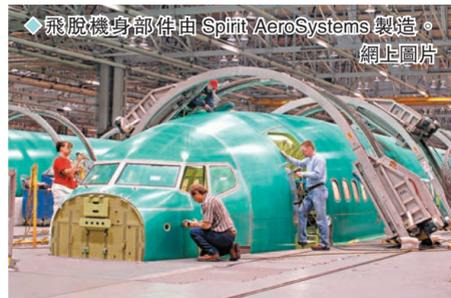
◆飛脫機身部件由Spirit AeroSystems製造。
