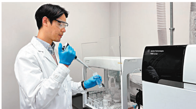
◆水務署化驗師利用電感耦合等離子體質譜儀檢測食水樣本的金屬含量。
