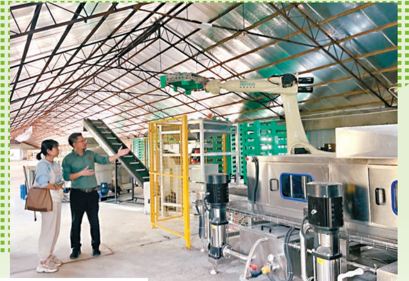
▲▼ARM機械人(上圖)取出培養盤，進行傾倒、清洗、再填入飼料、撒上黑水虻蟲苗一系列步驟後，再將培養盤送入後方密閉艙(下圖)，繼續下一輪的養殖。
