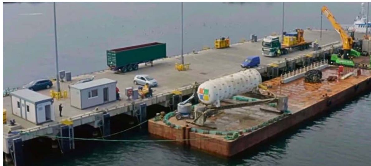
◆ 微軟曾試驗在水下設立數據中心，發現其效率高於傳統數據中心。圖為沉入海底前的微軟伺服器。
