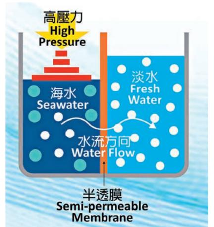
◆「逆滲透」原理是透過向含鹽分的海水加壓，使水分通過半透膜流向淡水方向，阻擋鹽分、雜質和微生物等，以淨化海水。
