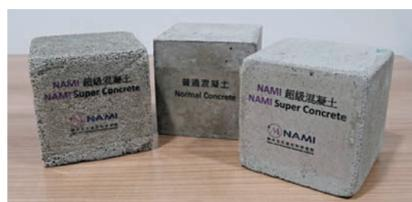
▲ 納米及先進材料研發院 (NAMI) 研發的高強度輕質混凝土 (左一及右一)。
