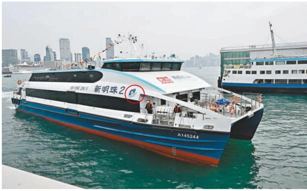
碳纖維物料建造，重量較以鋁合金建造輕約30%，降低使用馬力，減低氮氧化物的排放。
