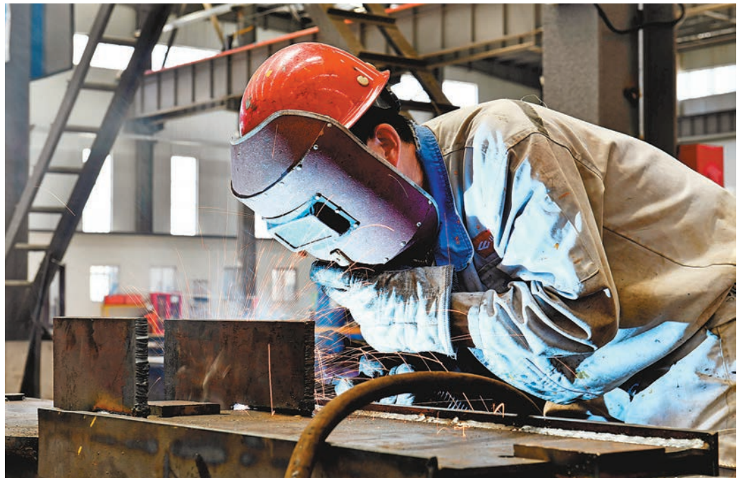
◆特種作業環境複雜，風險大，只有全面了解作業規範和安全措施，學習應急處理方法和自我保護技巧，才能減少風險事故。圖為工作人員在焊接智能行車設備。 資料圖片
