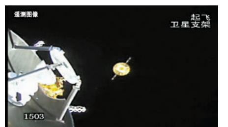
◆2024年3月20日，長征八號運載火箭衛星支架相機拍攝成像。鵲橋二號中繼星與運載火箭成功分離，太陽翼及傘天線順利展開，圖像左側為天都試驗星。國家航天局供圖
