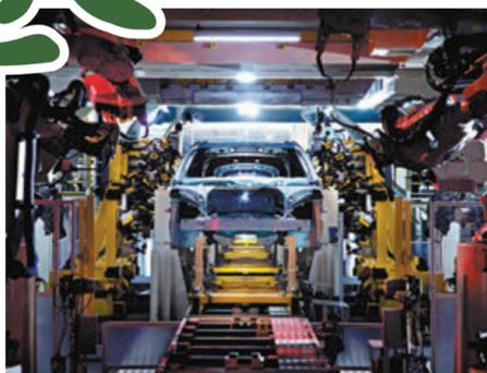
◆極氪智慧工廠焊裝車間。圖為熱融自攻絲並螺接的冷成型工藝。
