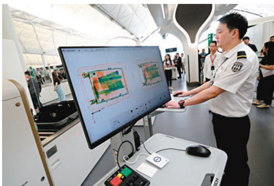
◆機管局由下月2日起分階段引入智能安檢系統，包括採用電腦斷層X光機，能呈現三維影像，掃描時間可縮短至10秒。 香港文匯報記者涂穴 攝
