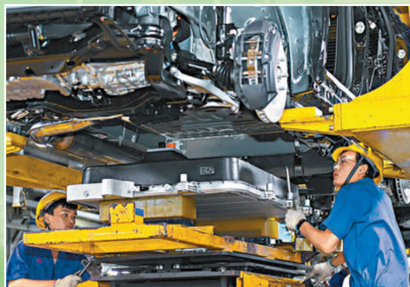
◆深圳比亞迪總部工人正在為新能源車安裝電池。網上圖片
