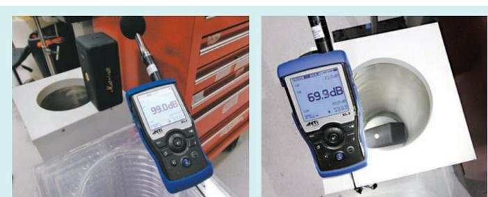
◆降噪測試中，在喇叭播放模擬大型風機的噪音達99分貝(左圖)，把喇叭放進吸音聲學超材料後(右圖)，分貝儀顯示噪音減少約30分貝。香港文匯報記者黃艾力 攝
