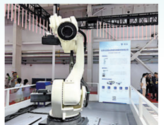
◆目前國產最大的工業機器人抓取重量可以達到1.2噸，能輕鬆抓起一輛汽車。香港文匯報記者郭瀚林攝
