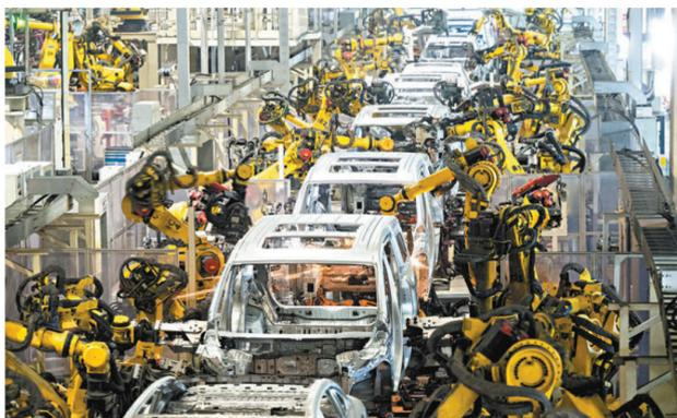
武漢嵐圖汽車電動化焊裝車間，機器人在流水線上作業。資料圖片
