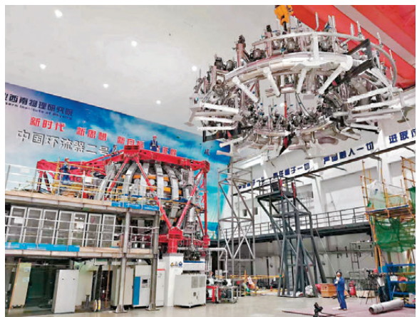
●新一代人造太陽裝置中國環流器二號M裝置前期進行烘烤和水冷管道安裝。 網上圖片
