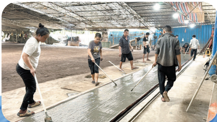
●經過反覆浸染和日曬加工的坯網在機器輔助下「鋪」上河泥，工人們正在消除坯網表面的河泥氣泡。
